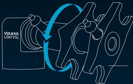
**360° STUFENLOS SCHWENKBARER DREHKOPF**
