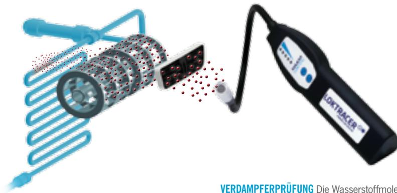
**VERDAMPFERPRÜFUNG** Die Wasserstoffmoleküle treten an der Undichtigkeit im Verdampfer aus und gelangen über die Belüftungsschlitze in den Fahrzeuginnenraum.
